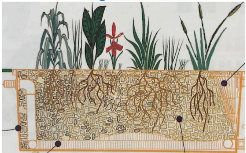
Le filtre Phytostep "Light" peut être placé hors sol ou partiellement voir totalement enterrées.
